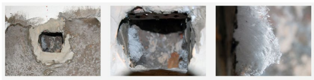
Efekt osuszania betonu - struktury krystaliczne Penetronu
